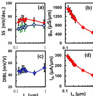
Fig. 8 (a) SS, (b) DIBL, (c)  $g_m$  and (d)  $I_{on}$  vs. various  $L_g$ .
