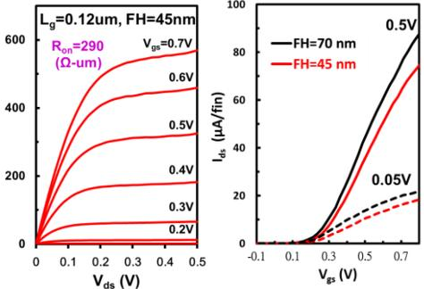
Fig. 6  $I_{ds}$ - $V_{ds}$  of  $L_g=120\text{nm}$  device.
